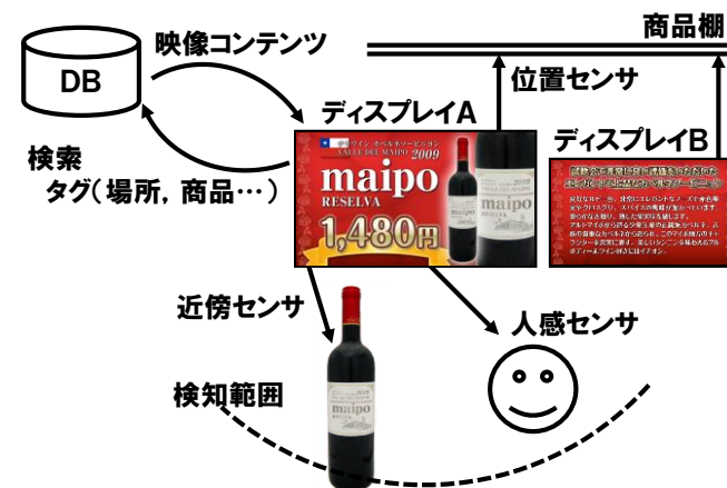
図 1 システム概要 Figure 1 System Overview.
