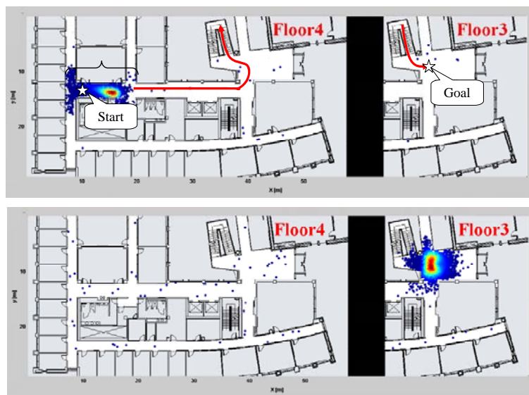
図 13 推定結果スクリーンショット Fig. 13 Screen shot of WiFi localization
