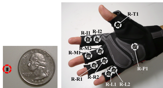
図 1 磁気センサ (左) とプロトタイプデバイス (右)。図のようにグローブ上のそれぞれのセンサに識別子を与えている。識別子の最初の文字が手の左右 (L または R) を表し、2 番目は手の部位、最後はシリアルナンバーを表す。例えば、右手の小指 (little finger) の 1 番目のセンサの識別子は R-L1 である。
