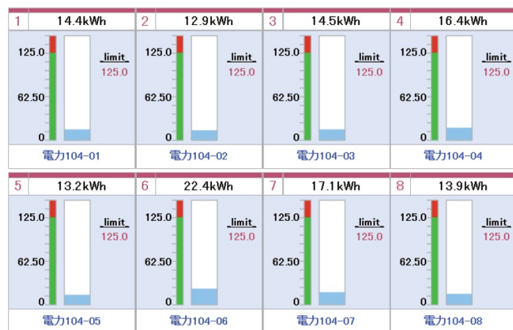
図 4 分電盤で計測された消費電力の1時間毎の積算値を Web 閲覧する様子。
