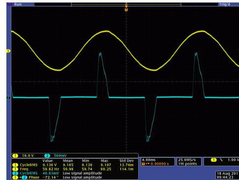
図 8 AC アダプタの電圧・電流波形
