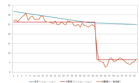
図3 実装したエアコンの電力消費モデルと実測値
