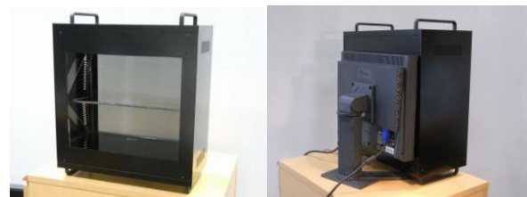
図 2 ディスプレイ盗撮防止ユニットの外観
