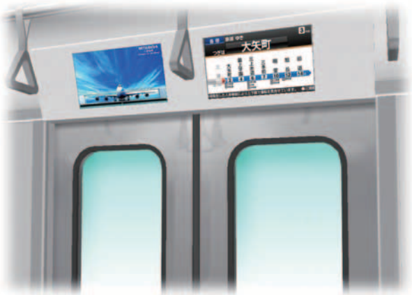
図-1 鉄道車両内に設置されたデジタルサイネージ(イメージ図)
