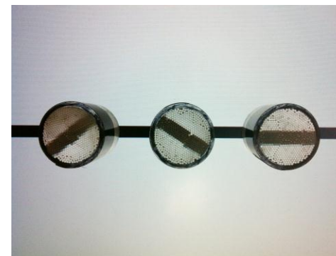
図5 ねじれのある ficon がディスプレイの映像を捻って映す様子.
