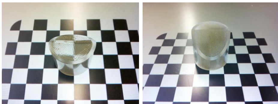
図6 斜めに切断した ficon における見え方の違い. 左図でははっきり見える映像が, 右図のように切断面に正対するとほとんど見えなくなる.
