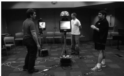
図 10 HARK を用いた Texai による多人数遠隔インタラクション：遠隔 Texai（中央）を通じて、遠隔操作者が 2 人の話者と、1 台の Texai とインタラクションを行う。なお、場所はカリフォルニア州であるが、左側の Texai はインディアナ州から遠隔操作中。
