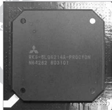
図-1 H.264 映像符号化 1 チップエンコーダ LSI の概観
