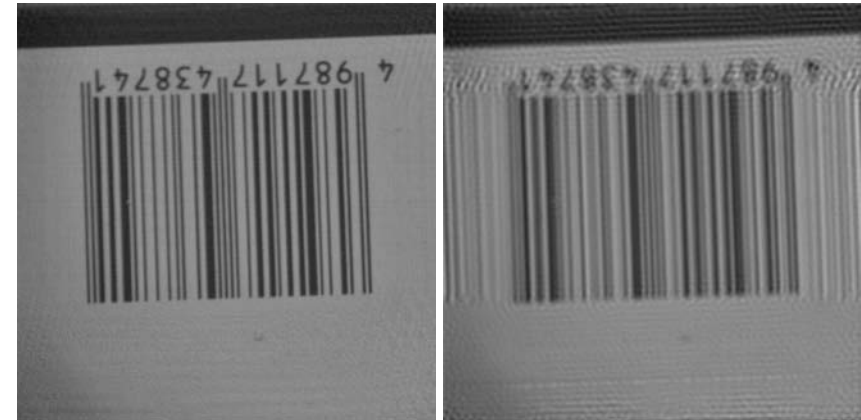
(a) 符号化開口を用いた復元画像 (分離度:3.97, 復元倍率:0.200) (b) 円形開口を用いた復元画像 (分離度:2.67, 復元倍率:-0.1)
