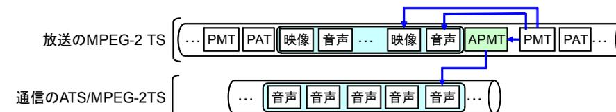
図 7 放送に多重する Advanced PMT による、通信で伝送するコンポーネントの参照
