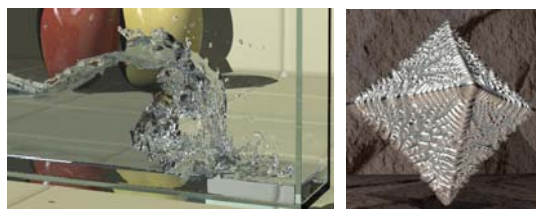
図4 界面捕獲法による気液二相流計算、フェーズ・フィールド法による金属の樹枝状凝固成長過程
