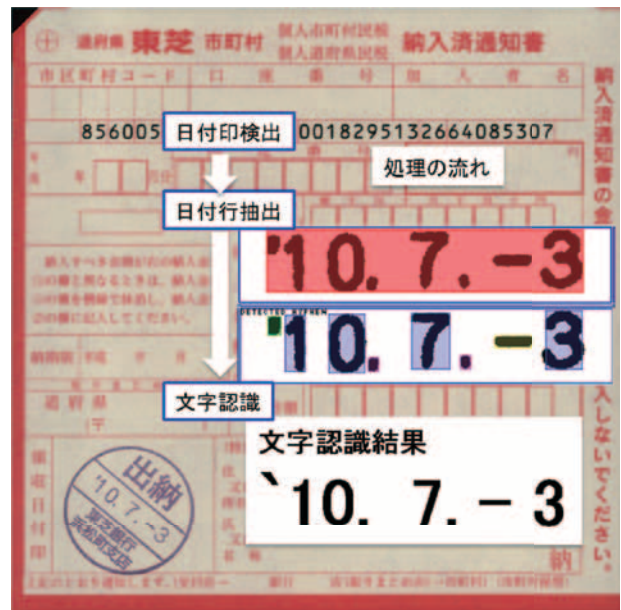
図-3 日付印認識処理の流れ
