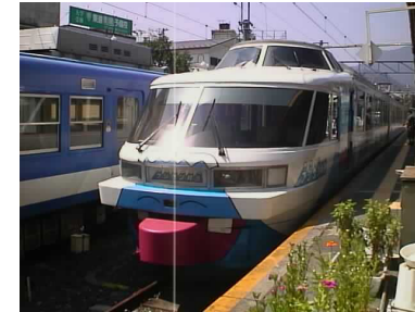
図 3 スミアの例．図中縦に伸びる白飛びした線をスミアと呼ぶ．輝点周辺の滲みはブルーミングと呼ぶ（「スミア」『フリー百科事典 ウィキペディア日本語版』より参照．2010 年 10 月 19 日（火）9:00 UTC，URL: http://ja.wikipedia.org ）
