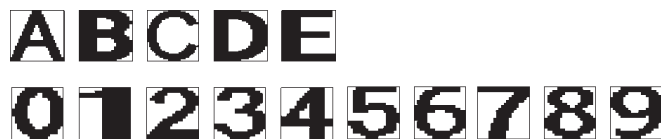
図 10 テンプレートマッチングのテンプレート Fig. 10 Standard images of the template matching.
