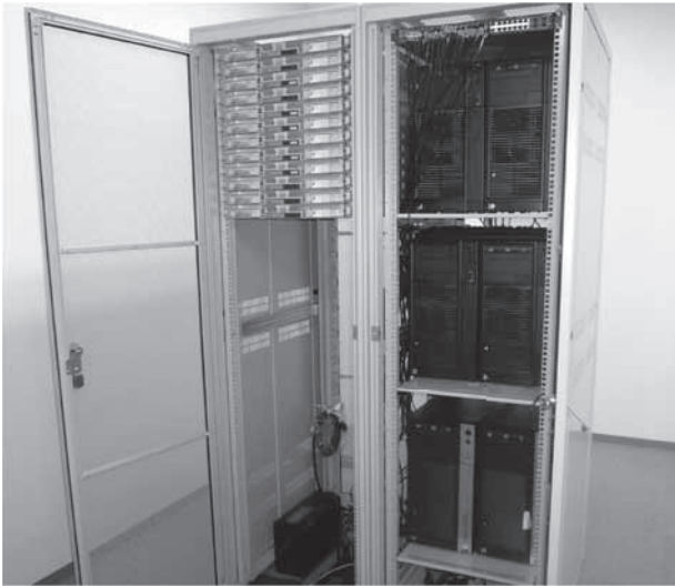
図-4 解読に利用したサーバ。Quad-Core Xeon 搭載のラックサーバ12台，Quad-Core Xeon × 2 搭載のサーバ6台の計18台。
