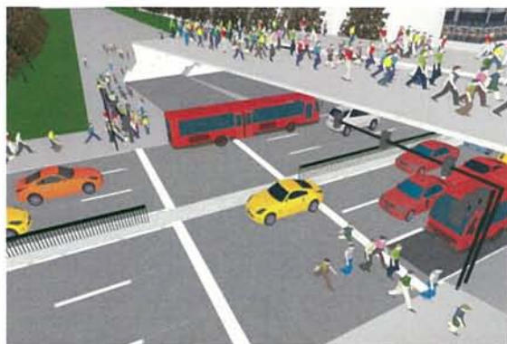
図 10 群衆シミュレータと統合した Aimsun for Legion 機能による分析画面
