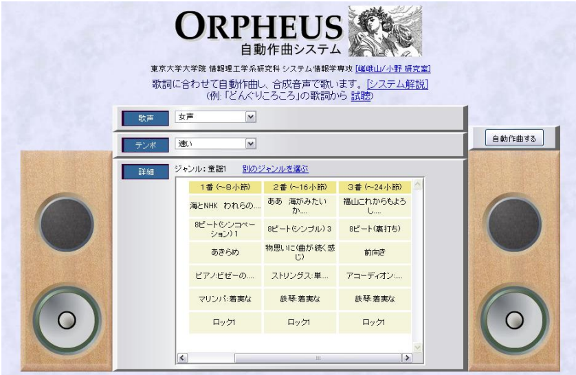
図 7 構成を持った歌唱曲を生成するためのインターフェイス: 改行で区切られた歌詞ごとにリズムパターン、和声進行、伴奏音型と伴奏楽器、ドラムスの有無を選ぶことができる。ここでは前半 2 つの部分の和声進行を「あきらめ」「物思いに」として暗い曲調に指定し、最後の部分の和声進行を「前向き」として暗から明へと変化する構成を作曲条件として設定している。各部位の条件設定に基づいて旋律が生成され、連結されたものが生成結果として出力される。
