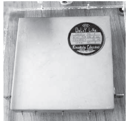
ETL Mark IIIに使用した金石舎研究所製の遅延線記憶素子(産総研所蔵) (コンピュータ博物館より)
