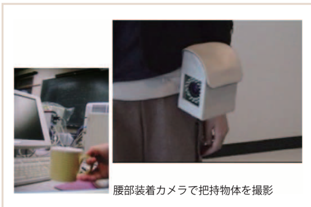
図-7 装着型物探し支援システム(奈良先端大)
