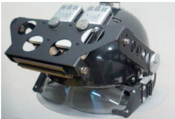
図-4 双曲面ハーフミラーを用いた頭部搭載型投影式ディスプレイ (HHMPD)
