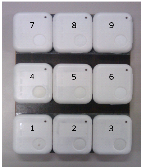
図 5 9 個のセンサを配置した実験用盤面 Fig. 5 An experimental board with nine sensors.
