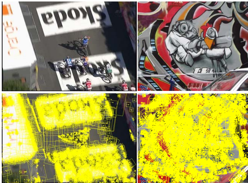
図 1 2 枚の画像, Tour de France 12) と Graffiti 13) , に対する局所領域の設定例. 上: 原画像. 下: 局所領域の設定結果. 特徴点およびエッジに基づいて, 局所領域を設定している 5) . 対応付けや物体認識の性能向上のためには, この例のように, 画像内に局所領域を密に設定する必要があることが指摘されている 5)-7) .
