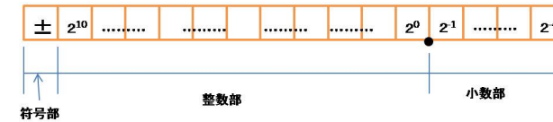
図1 Qフォーマットの固定小数点数 Fig.1 Fixed point number of Q format
