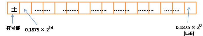
図2 車載ソフトウェアで一般的に用いられるフォーマットの固定小数点数 Fig.2 Fixed point number of format used with in-vehicle software
