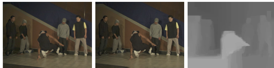
(a) 原画 (b) 合成画像 (c) デプスマップ 図 2 視点合成画像と合成に用いたデプスマップの品質
