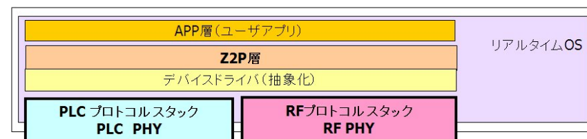
図2 PLC/ZigBee 相互補完通信プロトコル
