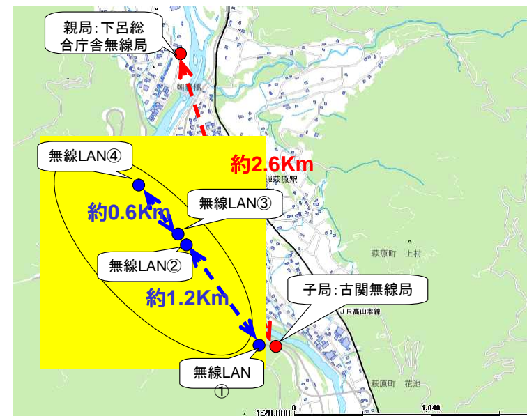
図6. 「通信と放送の伝送路融合型」18/19GHz帯無線アクセスシステムの伝送実験
