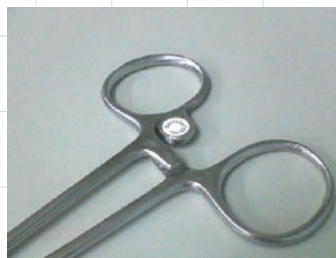
図-5 手術用器材（鉗子）へのセラミックタグの活用（外側への取り付け）
