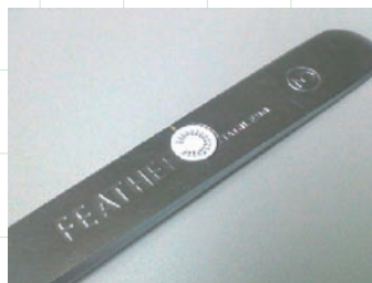
図-6 手術用器材（メス）へのセラミックタグの活用（埋め込み式による取り付け）
