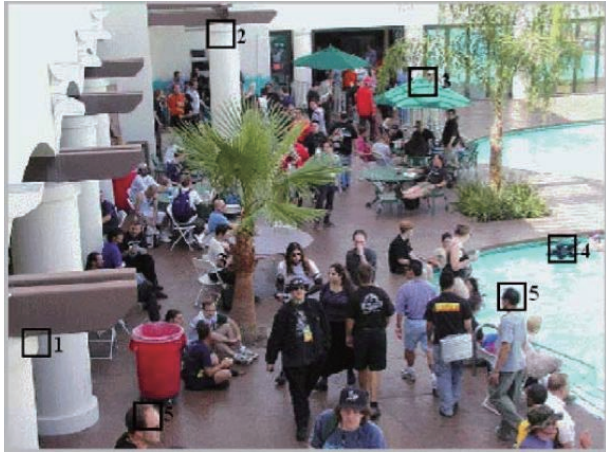
図-6 PassPointsの画面例。ユーザの選択した場所と順番が正方形と数字で示されている。認証時にはこれは表示されない。
