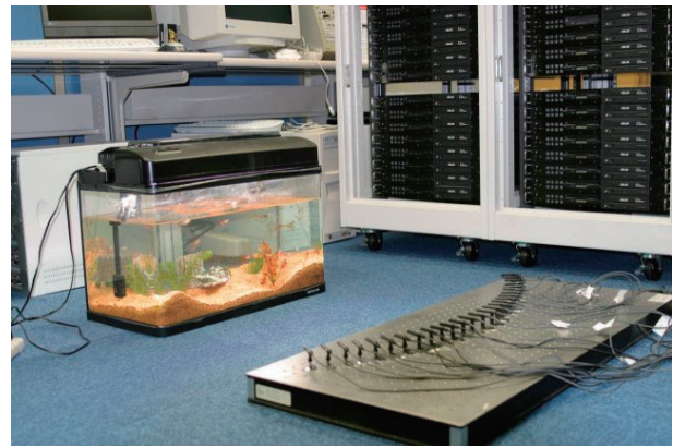
図-4 自由視点テレビシステム(FTV) —多視点カメラとPCクラスタによる並列信号処理—
