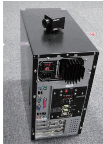
図-6 映像・音声記録ユニット(画像1チャンネル, 音声4チャンネル)
