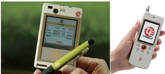
図-6 ユビキタスコミュニケーター(左)とUC-Phone(右) ユビキタスコンピューティング環境と人間のインタフェースとなるコミュニケーションマシン、複数の電波周波数とプロトコルのRFIDに対応したインタフェースを備えている。
