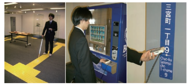
図-4 自律的移動支援のデモンストレーション (左)白杖が点字ブロックに仕込まれたRFIDから情報を読み取る。 (中)UCと自動販売機が非接触通信で交信。 (右)番地表示に埋め込まれたRFIDから場所情報を取得している街のあちこちにRFIDや赤外線発信機が設置されており、その場所のucodeを取得し、それに基づいた情報サービスを受けることができる。
