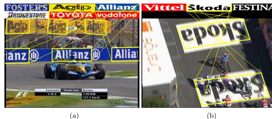
図 4 GPU による実装により抽出された特徴量を使用した，放送映像内のロゴの検出結果．(a)F1 26) ．(b)Tour de France 27) ．検出は，文献 28) の対応付けに基づくアルゴリズムで行った．
