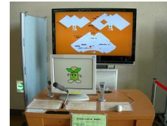
図1 音声情報案内システム「たけまるくん」 Fig.1 Speech-oriented guidance system "Takemaru-kun."
