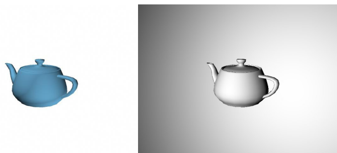
図 7 3次元 CG 画像 (左) と各ピクセルを通るレイが形状と交わった点における法線の傾きをグレースケール表示した画像 (右)
