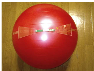
図6 微小発電機構を取り付けたバランスボール
