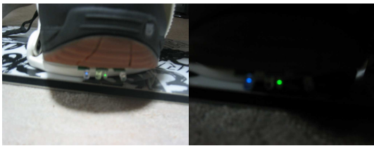
図8 スノーボードで発電し、LEDを点灯させた様子
