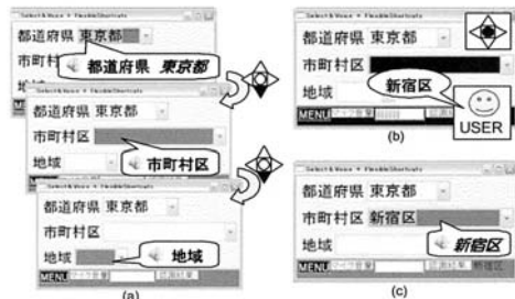
図 1: Select&Voice (a) 上下ボタンで項目を選択, システムは選択された項目名と入力されている値を読み上げる。(b) 発話ボタンを押しながら選択した項目に対し音声入力をする。(c) 認識結果を表示し、読み上げる。
