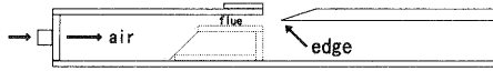
Fig. 1: 試験用オルガンパイプ (フルーの形状を変えることができる)。本研究ではパイプ部は除外した。
