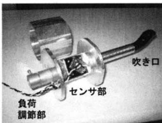
図 1: 呼吸測定部の構造
