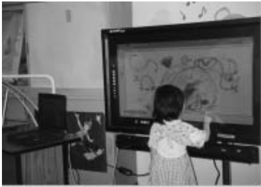
図 3-1 タッチパネルつきプラズマディスプレイ
