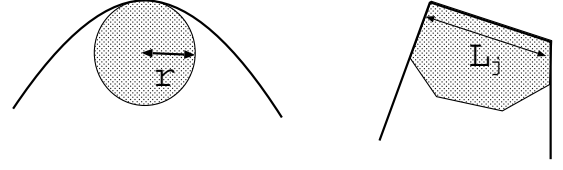
図 4: 左: 通常の曲率は内接円の半径の逆数. 右: nonlocal weighted curvature は Wulff 図形を拡大または縮小して内接させたときの倍率の逆数.
