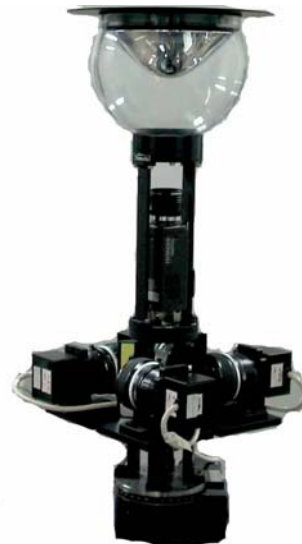
図 9 高解像度全方位視覚センサ Fig. 9 High resolution omnidirectional image sensor
