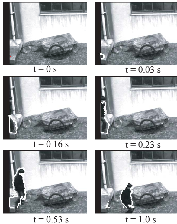
図4 移動物体のリアルタイム追跡 Fig. 4 Realtime tracking of single object.
