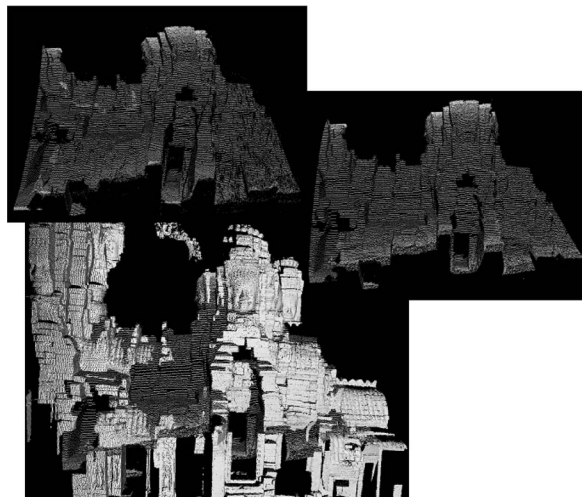
図7 気球の運動が激しい場合のデータ:左上 FLRSから得られたオリジナルデータ,右上 提案手法によって修復したデータ,下 Cyrax2500によって得られたデータと修復したデータとを位置合わせしたしたもの
