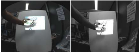
図 7: 魚眼カメラからの入力画像（左）と透視射影変換した結果（右）.
