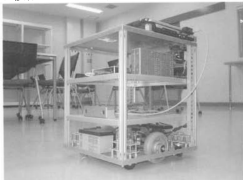
【図3】ステレオビデオカメラを備えた使用ロボット Fig.3 Stereo video camera and robot platform
