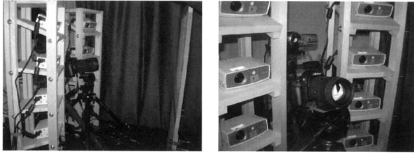
図 10: 実験装置. 左: 8 台のプロジェクタとスクリーンの位置関係, 右: 奥がキャリブレーション用の (ビデオ) カメラ, 手前が実現画像の画質検証用のカメラ.
