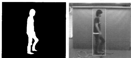
図3 フレーム間差分による人体の検出
