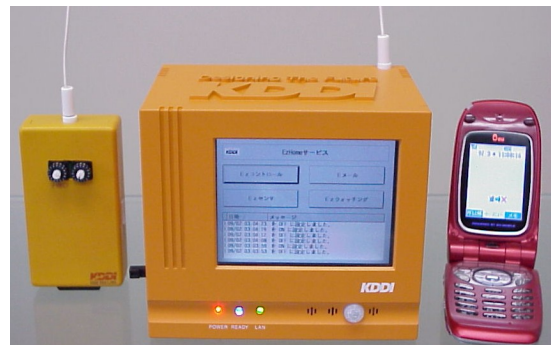
図 5 ユビキタスノードの外観 (中央がゲートウェイ親機、左がコントローラ子機)。
